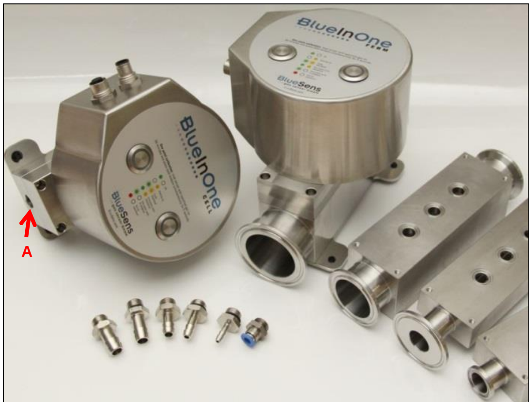
Abb. 5: Diverse Anschlussmöglichkeiten für Schläuche und Rohre. Die Bohrung im Durchflussadapter (A) hat ein 1/4" Gewinde. Der Durchflussadapter kann getauscht werden, so dass Gewinde bis 1 1/4" möglich sind. Weitere Bauformen können auf Anfrage realisiert werden.
