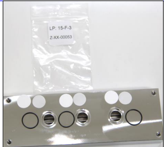
Abb. 31: Neue Filter und Dichtungen
