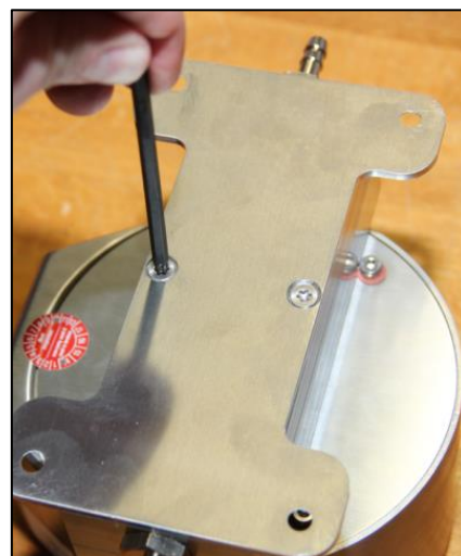
Abb. 4k: Montageplatte befestigen
