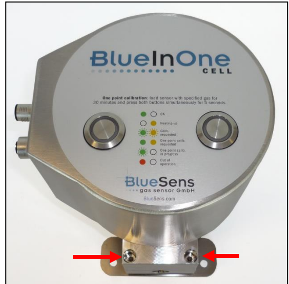
Abb. 28: Schrauben zur Befestigung des Sensors auf dem Durchflussadapter
