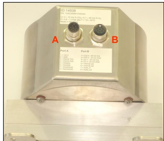
Abb.6: Anschlussstecker A und Anschlussbuchse B des BlueInOne
